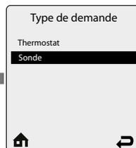
La fonction **Type de demande** permet de sélectionner le type de capteur qui initiera une demande de production d'eau chaude sanitaire. Toucher le bouton tactile de déplacement vers le **HAUT** ou le **BAS** pour sélectionner le type de capteur, puis le bouton tactile **OK** pour sauvegarder le réglage.
