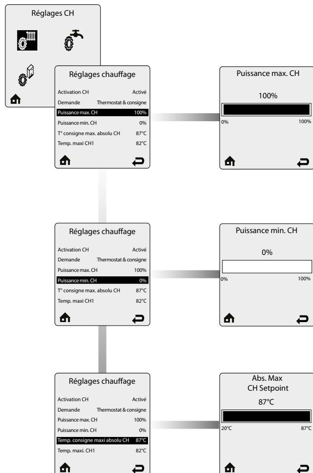
**Puissance max. CH** limite la puissance maximale du circuit chauffage. La puissance de l'appareil peut être définie en réglant ce paramètre; 100% signifie une puissance maximale du circuit CH, 0%, une puissance minimale. Il est donc possible d'adapter la puissance du circuit CH aux besoins de l'installation.
