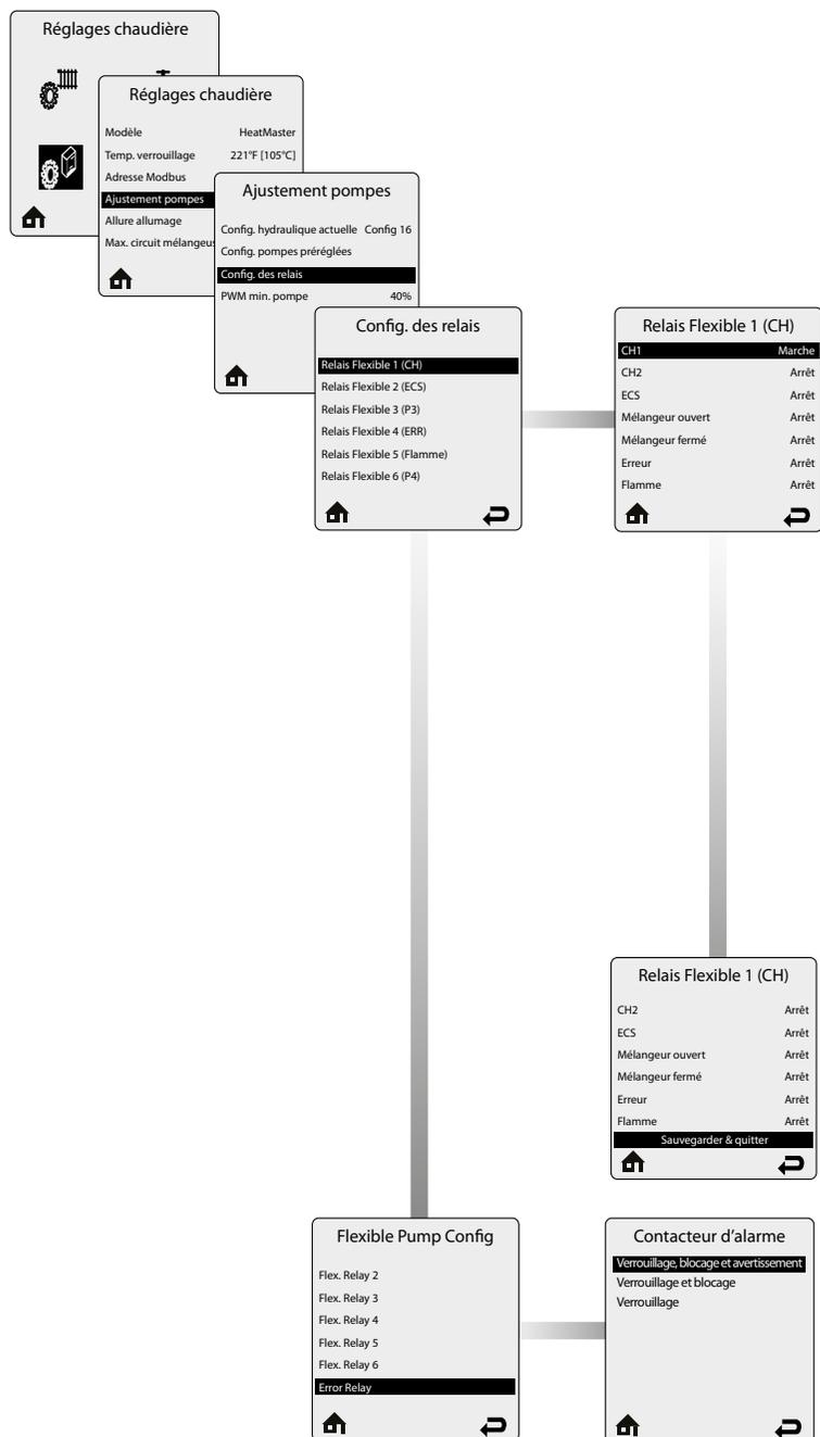
Chaque relais peut remplir plusieurs fonctions. L'activation aura lieu lorsque l'une des options suivantes est sélectionnée : **CH1, CH2, DHW, MIX OPEN, MIX CLOSE, ERROR, FLAME**.
