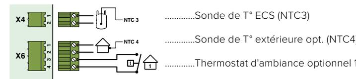
**i** Pour les caractéristiques de la sonde de température extérieure, voir "[Résistance des sondes de température](#)" à la page 36
