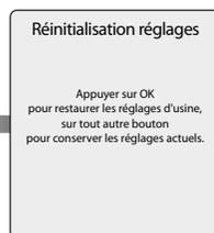
**Réinitialisation réglages** permet à l'installateur de ramener tous les paramètres à leurs valeurs d'usine (aller à [«Valeurs d'usine et de réinitialisation»](#) pour voir les paramètres par défaut).
