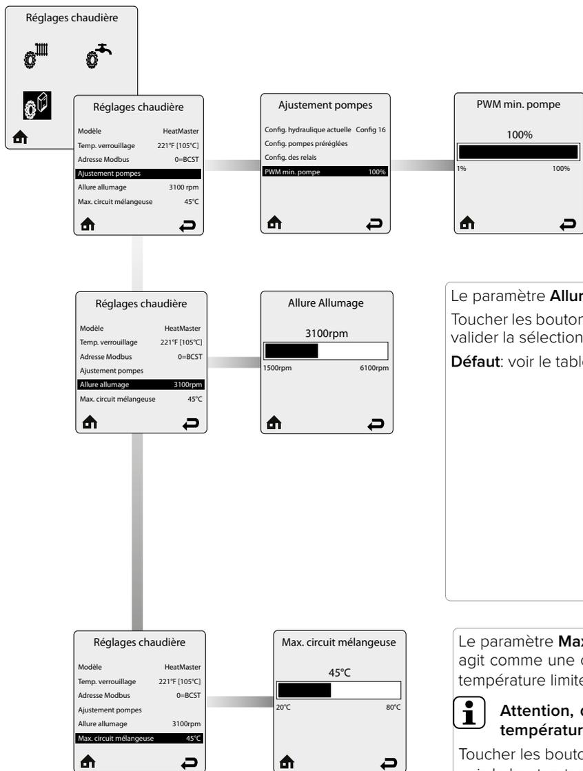
La fonction **PWM min. pompe** permet d'adapter la valeur minimale de fonctionnement de la pompe si le débit dans l'appareil ou l'installation est insuffisant à la puissance minimale de l'appareil.
