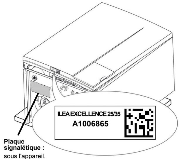
fig. 2 - Situation de la plaque signalétique et étiquette réglage gaz
