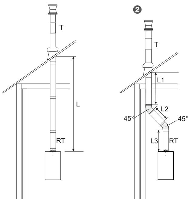
RT - Conduit télescopique. T - terminal (maxi 1 m).
