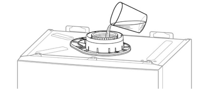
fig. 16 - Remplissage du siphon
