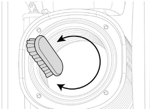
Utiliser une BROSSE NYLON exclusivement. NE PAS UTILISER DE BROSSE MÉTALLIQUE. L'utilisation d'une brosse métallique endommage irrémédiablement l'échangeur thermique.
