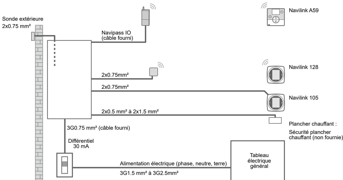
fig. 18 - Schéma d'ensemble des raccordements électriques
