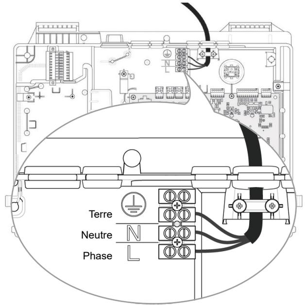
fig. 32 - Remplacement du câble d'alimentation
