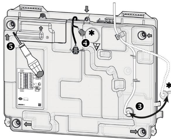
\* Après la fermeture du coffret, ne pas oublier de brancher les câbles d'allumage et PASS :
