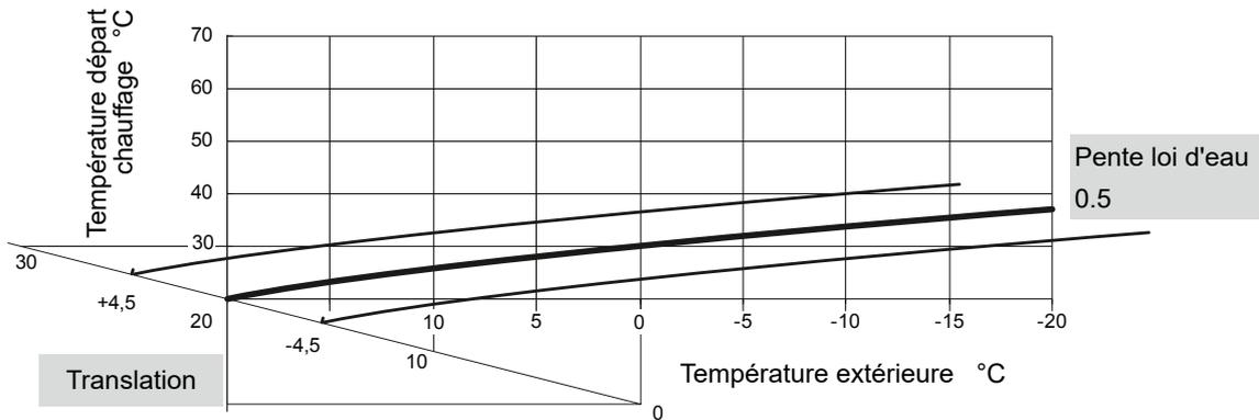
fig. 24 - Translation de la courbe de chauffe (Paramètres 31 / 41)
