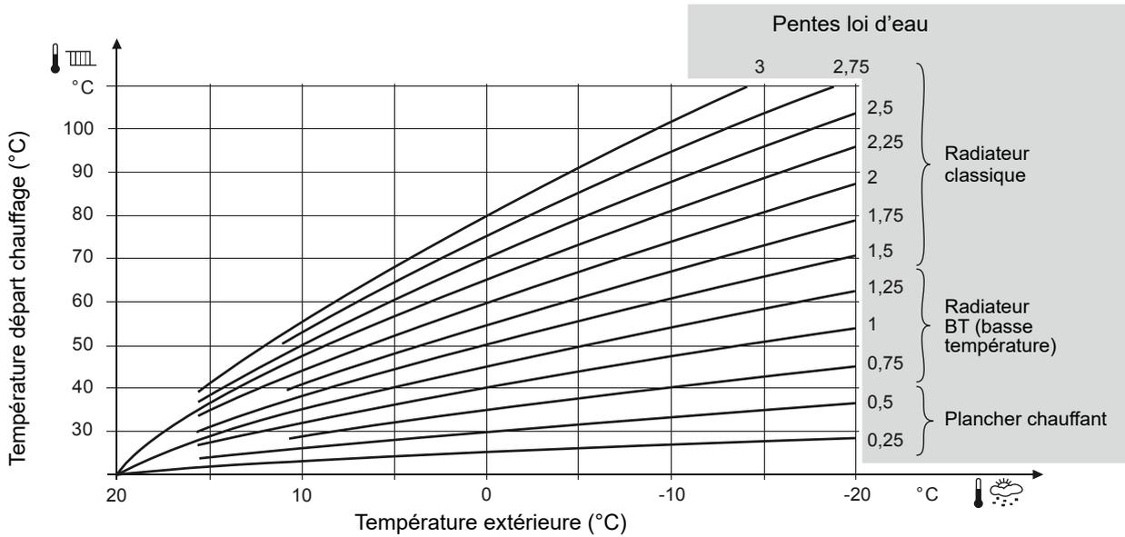
fig. 23 - Pente de la courbe de chauffe (Paramètres 30 / 40)
