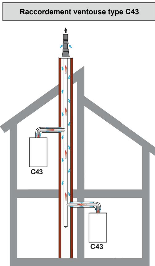
fig. 10 - Possibilités de raccordement (type 43)
