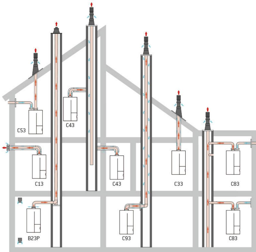
Les raccordements des conduits (concentriques ou cheminée) doivent être parfaitement étanches.
