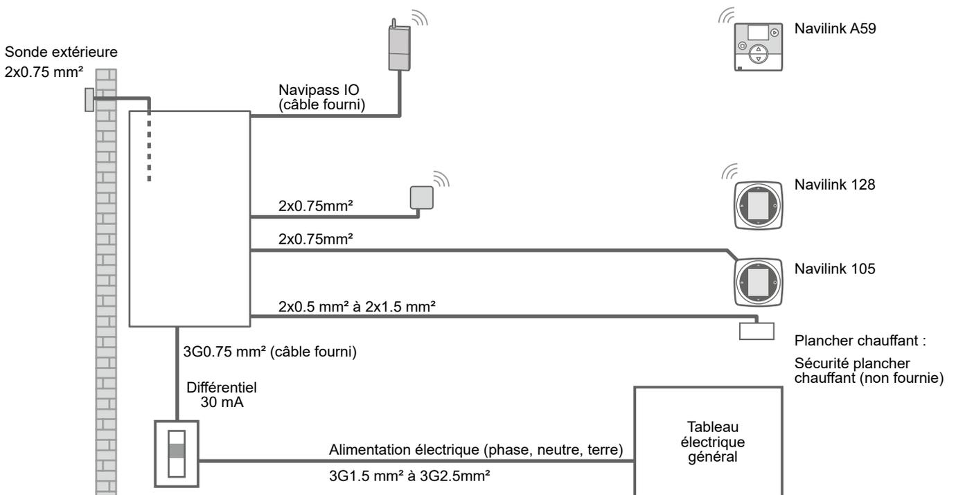
fig. 20 - Schéma d'ensemble des raccordements électriques
