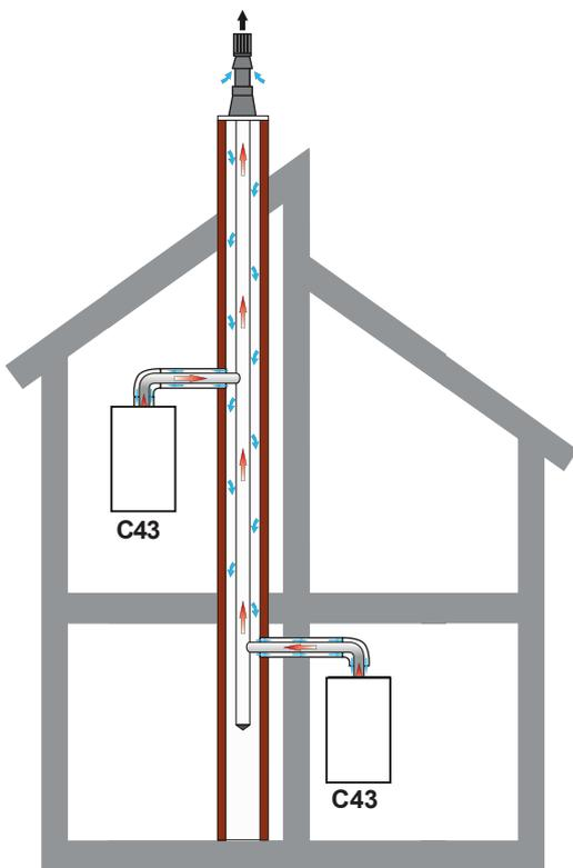
fig. 12 - Possibilités de raccordement (type C43)
