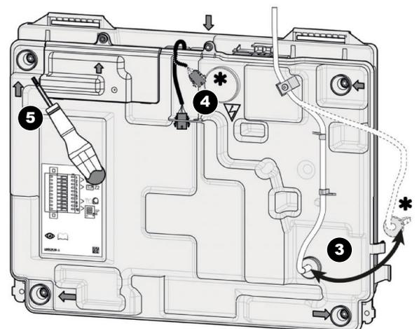
\* Après la fermeture du coffret, ne pas oublier de brancher les câbles d'allumage et PASS :
