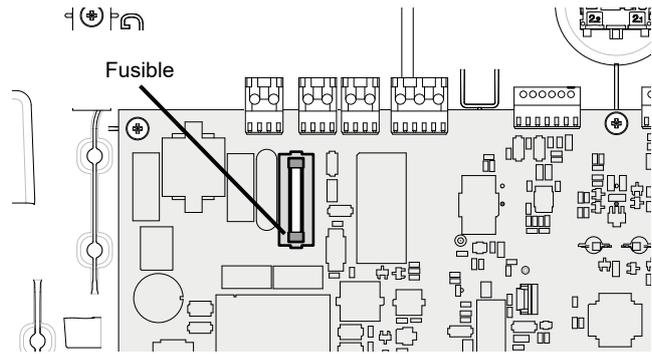
fig. 36 - Remplacement du fusible
