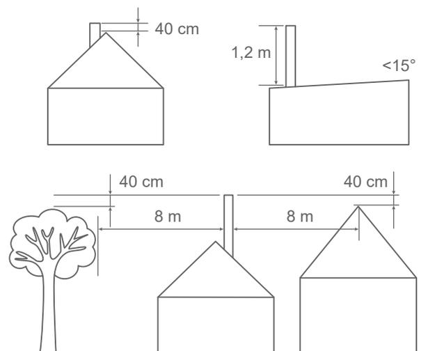
fig. 15 - Hauteur de la souche du conduit d'évacuation (B23, B23p)
