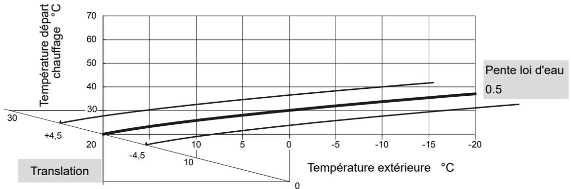
fig. 29 - Translation de la courbe de chauffe (Paramètres 31 / 41)
