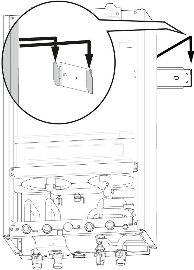
**3** Déposer l'équerre de verrouillage.
