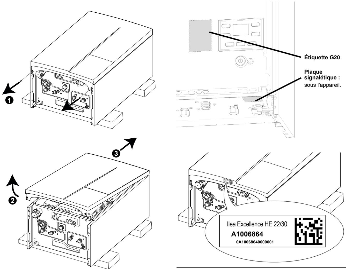
fig. 2 - Plaque signalétique et étiquette réglage gaz
