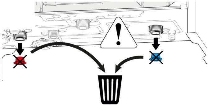
**2** Raccorder l'installation sur le dossieret Hydro Efficiency en respectant le sens de circulation. Utiliser les joints fournis. Serrer les raccords.
