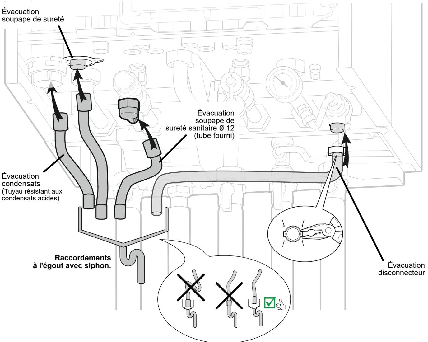
fig. 17 - Raccordements des évacuations
