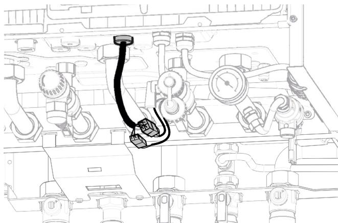
fig. 23 - Raccordement sonde ECS et débitmètre
