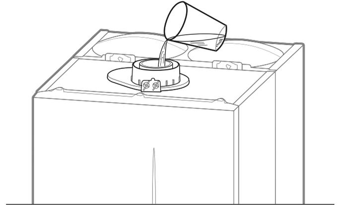
fig. 18 - Remplissage du siphon
