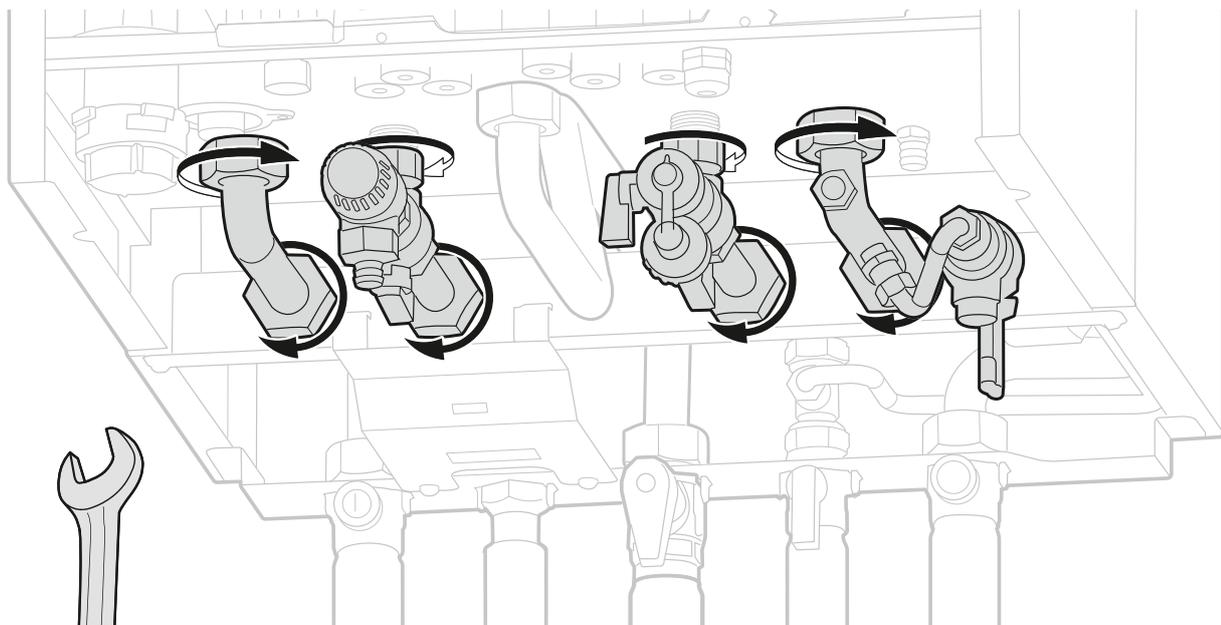
**6** Raccorder le manomètre sur le dossieret Hydro Efficiency.
