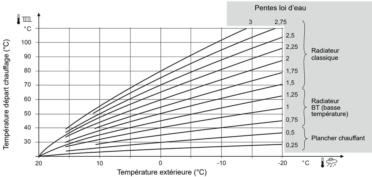
fig. 28 - Pente de la courbe de chauffe (Paramètres 30 / 40)
