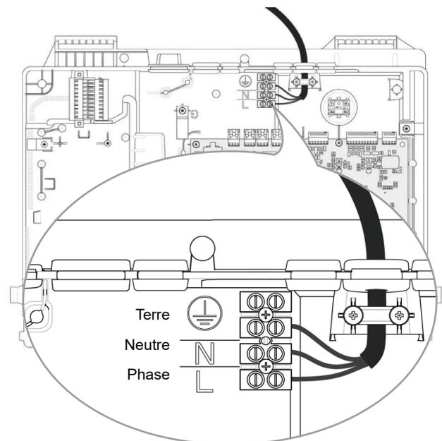
fig. 37 - Remplacement du câble d'alimentation
