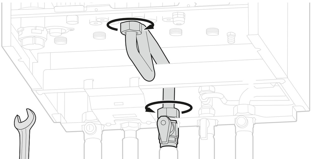
**7** Déposer l'équerre de verrouillage.
