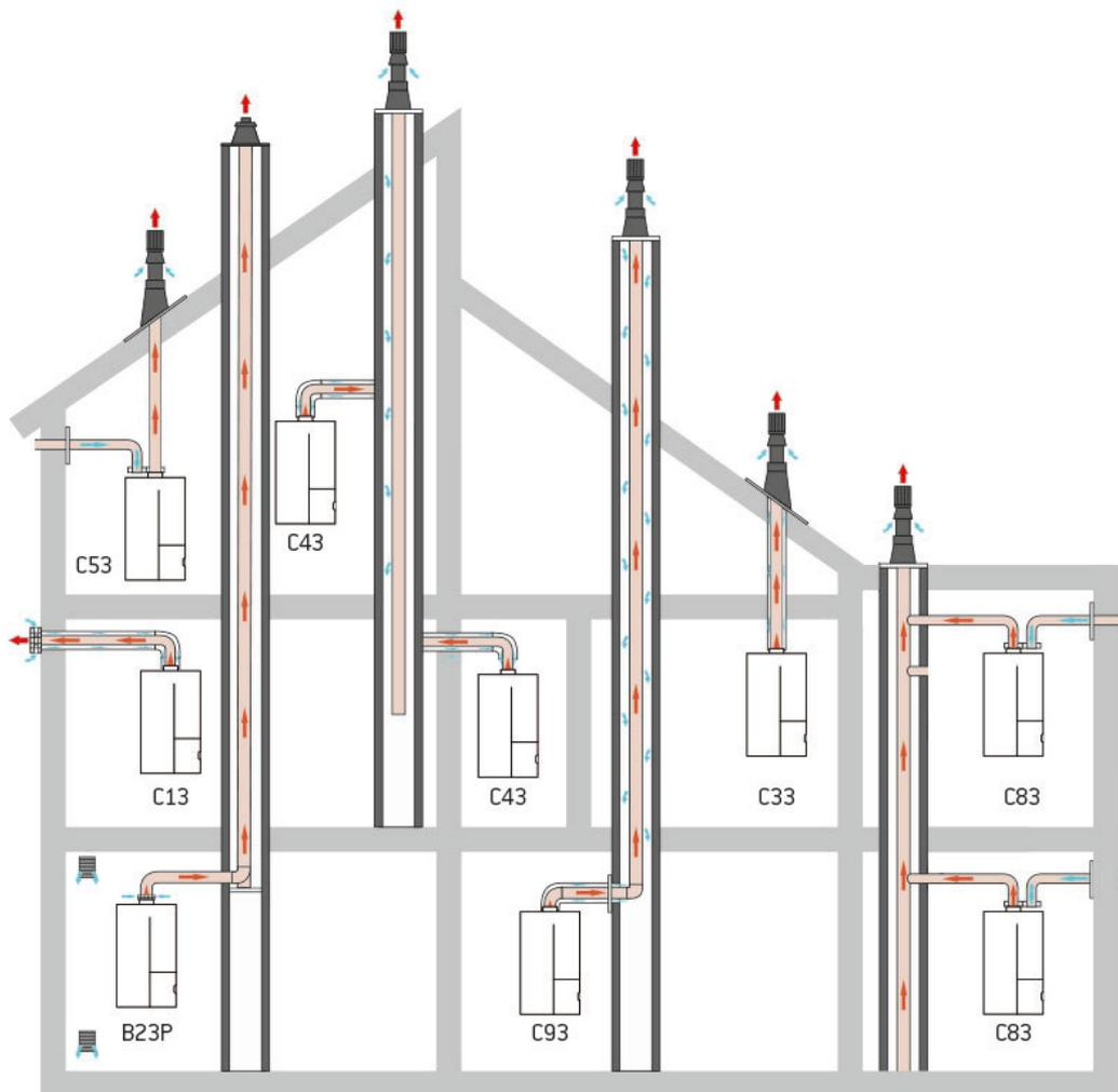
Les raccordements des conduits d'évacuation des fumées et concentriques doivent être parfaitement étanches.
