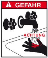
**Das Warmwasser kann Temperaturen von über 60°C erreichen. Es besteht Verbrühungsgefahr. Daher empfiehlt sich der Einbau einer thermostatischen Mischbatterie direkt hinter dem Gerät.**
