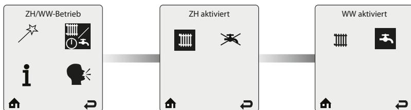
**ZH-/WW-Betrieb** bietet einen einfachen Weg zur Aktivierung/Deaktivierung entweder der ZH- oder der WW-Funktion des HeatMaster.
