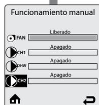
**FAN** (Ventilador) – Pulse el botón **OK** cuando el icono FAN está iluminado para disparar manualmente el quemador y encender la bomba de circulación CC1.
