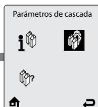
El menú **Parámetros de cascada** contiene **parámetros relacionados con el funcionamiento en cascada**. Cada línea contiene un parámetro de cascada seguido de su valor actual. En la pantalla se muestran seis Parámetros de Cascada al mismo tiempo.
