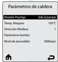
El menú **Modelo** indica el modelo y, posiblemente, el tipo de aparato para los que el sistema está configurado.
