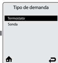
**Tipo de Demanda** permite al instalador seleccionar el tipo de dispositivo que va a generar una llamada de agua caliente sanitaria. Pulse el botón **ARRIBA** o **ABAJO** para seleccionar el tipo de demanda; a continuación, pulse el botón **OK** para guardar la configuración.
