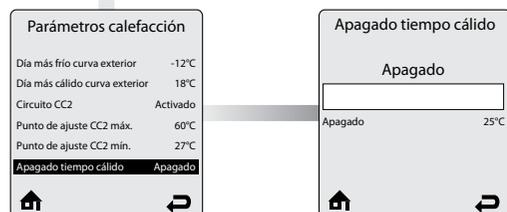
**Apagado Tiempo Cálido** permite añadir una temperatura exterior opcional por encima de la cual se desactiva la función de calefacción central. El aparato seguirá respondiendo a una llamada de agua caliente sanitaria o una modulación de señal de entre 0 – 10 V cuando la temperatura exterior supere el parámetro señalado en Apagado Tiempo Cálido.
