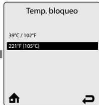
El parámetro **Temp. bloqueo** de la caldera permite comprobar la función Sobrecalentamiento de Termostato a una temperatura reducida. Disminuye temporalmente la temperatura de sobrecalentamiento del aparato hasta 39 °C, lo que permite una comprobación segura de la función.
