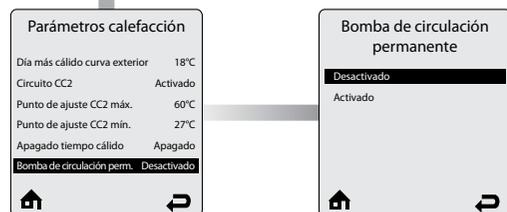
**Bomba de Circulación Permanente** permite que las bombas de circulación de calefacción central estén activadas constantemente, incluso sin una llamada de calefacción central. Una llamada de agua caliente sanitaria hará que las bombas de circulación se desactiven durante la llamada interna, siempre y cuando la prioridad de ACS está habilitada.
