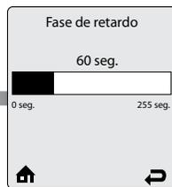
**Fase de retardo** ajusta la demora de tiempo previo a la activación o desactivación de una caldera en el sistema en cascada. La fase de demora comienza una vez que la caldera maestra determina que una caldera debe estar activada para alcanzar el punto de ajuste o cuando la caldera maestra determina que una caldera debe apagarse debido a una carga decreciente.
