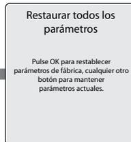
**Restaurar Todos los Parámetros** permite al instalador reiniciar todos los parámetros de CC, ACS, y en cascada en sus valores de fábrica originales. (Véase ["Parámetros de fábrica y valores originales"](#) para los valores de fábrica originales).
