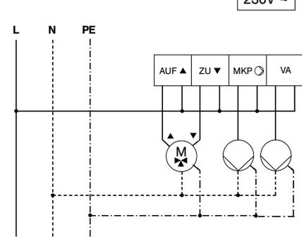
**VA:** Sortie variable selon la programmation dans le niveau HYDRAULIQUE
