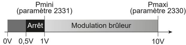
Le calcul de la modulation du brûleur générée est effectué d'après les vitesses mini et maxi OEM du ventilateur (consigne mini : paramètre 9525 / consigne maxi : paramètre 9530).
