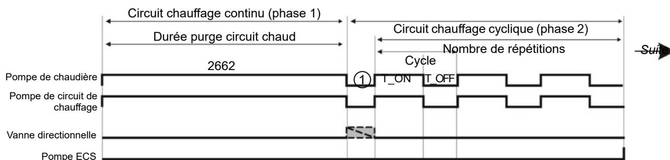
① Temps d'ouverture de la vanne mélangeuse chauffage / vanne 3 voie
