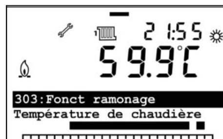
\* Signal de forçage : provoque l'enclenchement des pompes, et/ou l'ouverture des vannes 3 voies des circuits de chauffage raccordés, afin d'évacuer les calories.
