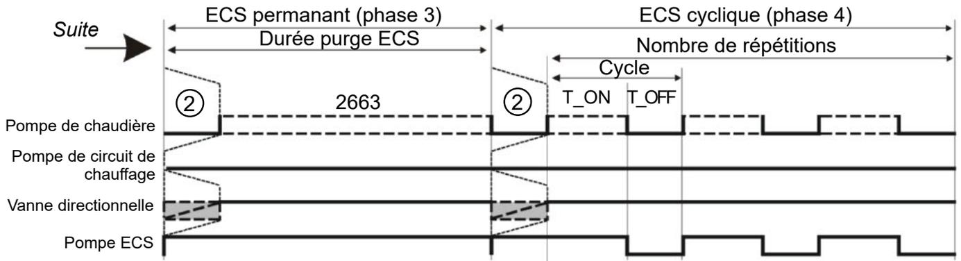
② Temps d'ouverture de la vanne 3 voies après ECS (en cas de paramétrage de *Vanne directionnelle disponible*).
