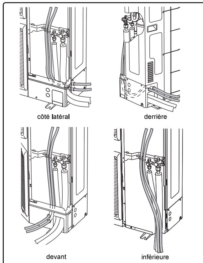
**figure 31 - Passages des câbles et liaisons frigorifiques de l'unité extérieure**
