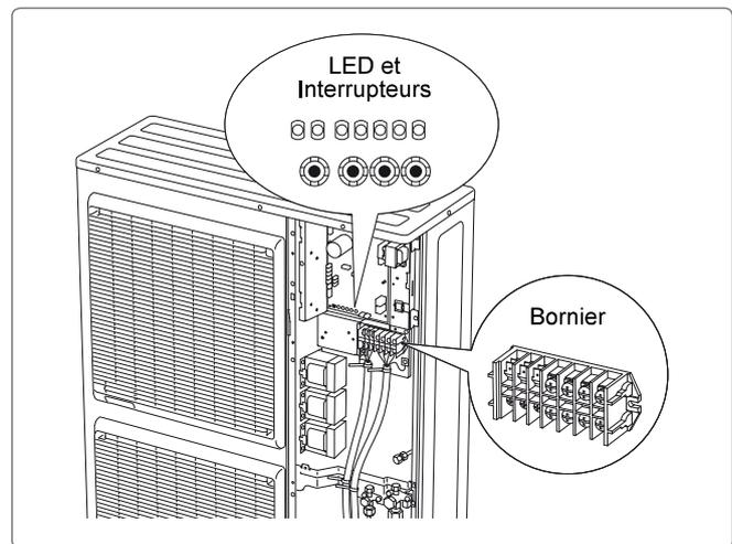
figure 38 - Emplacement des interrupteurs et LED de l'unité extérieure
