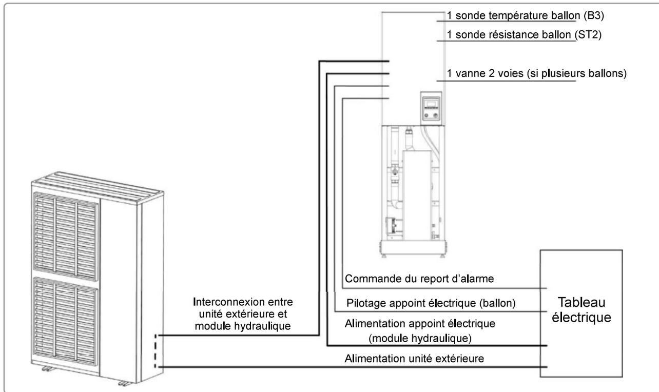
figure 26 - Schéma d'ensemble des raccordements électriques - 1 PAC
