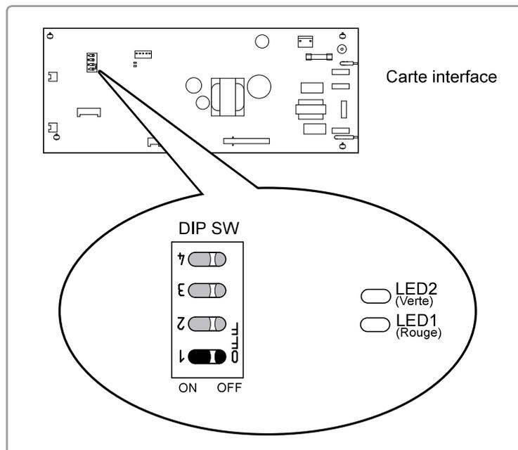
figure 24 - Emplacement des interrupteurs DIP et des LED sur la carte d'interface de la station hydraulique
