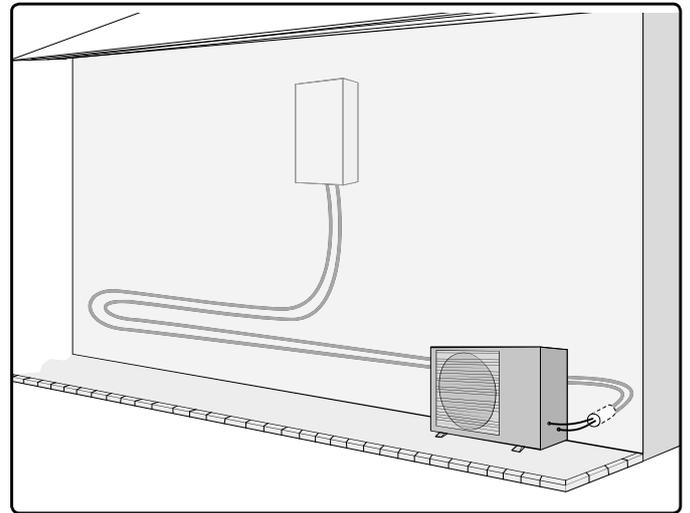
figure 15 - Exemple conseillé de disposition des liaisons frigorifiques
