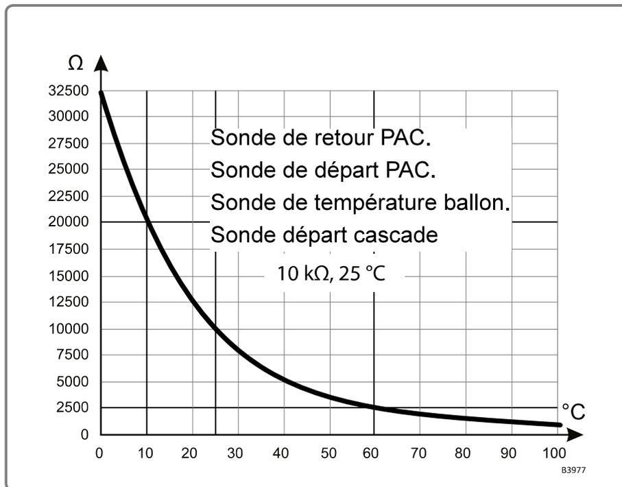
figure 5 - Valeur ohmique des sondes (station hydraulique)
