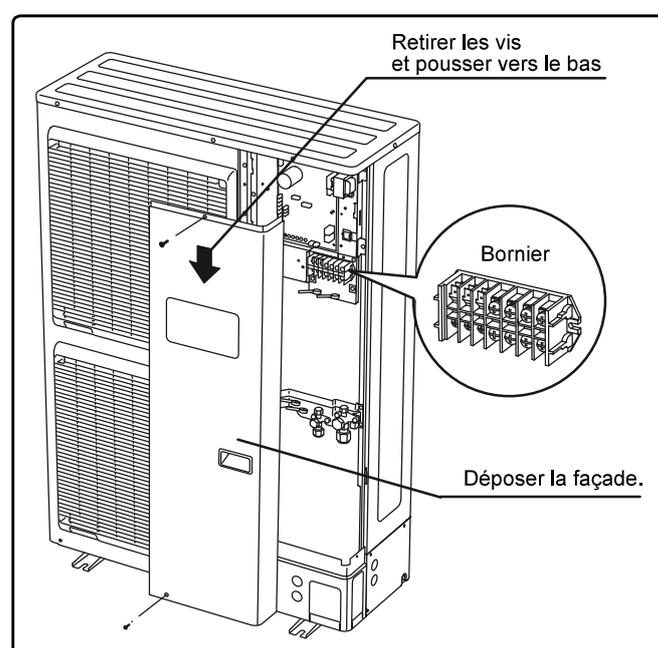
figure 28 - Accès au bornier de l'unité extérieure
