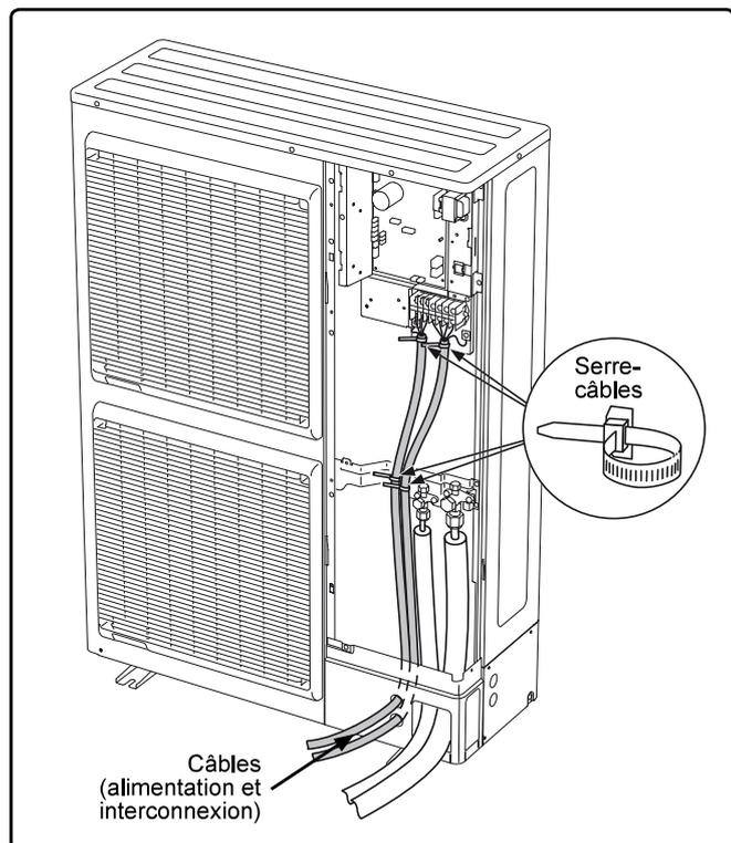
**figure 30 - Finalisation de la connexion de l'unité extérieure**
