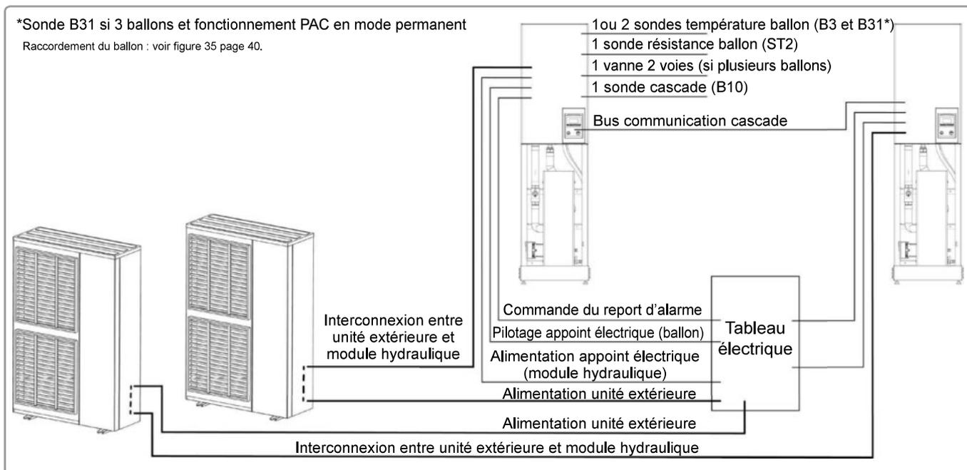
figure 27 - Schéma d'ensemble des raccordements électriques - plusieurs PAC avec gestion cascade
