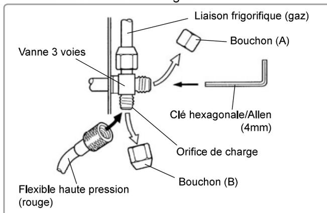
figure 21 - Raccordement du flexible sur la vanne gaz
