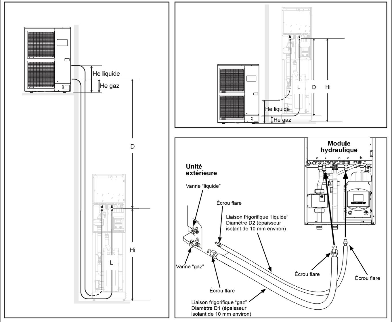
figure 18 - Raccordement des liaisons frigorifiques (diamètres et longueurs permises)
