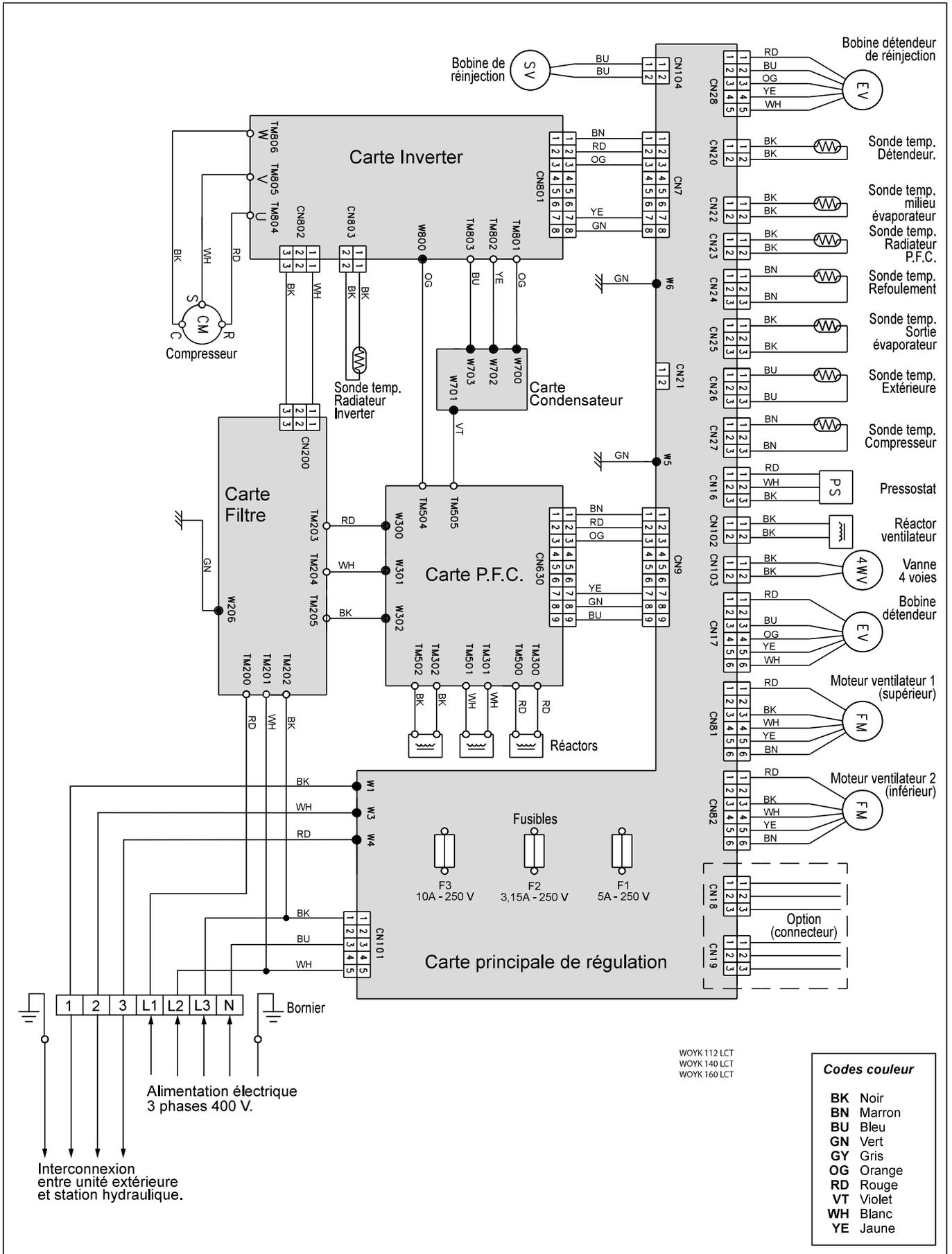
figure 32 - Plan de câblage de l'unité extérieure
