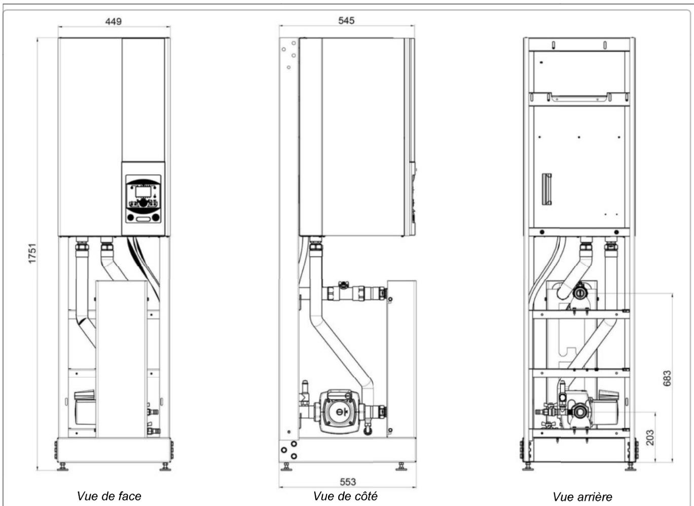
figure 3 - Station hydraulique : dimensions en mm
