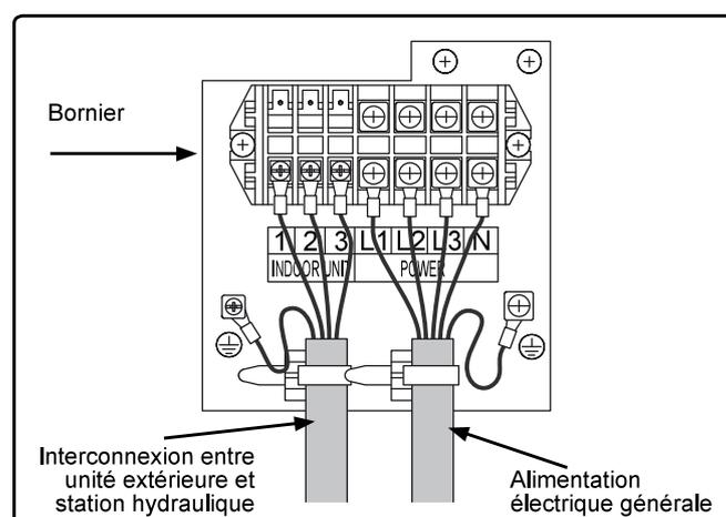
figure 29 - Connexions au bornier de l'unité extérieure
