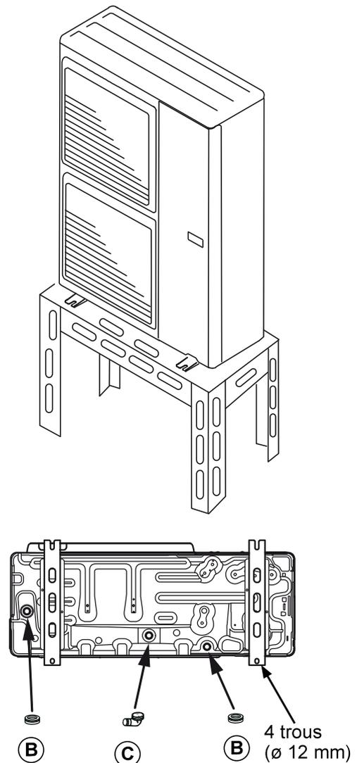
figure 12 - Pose de l'unité extérieure, évacuation des condensats
