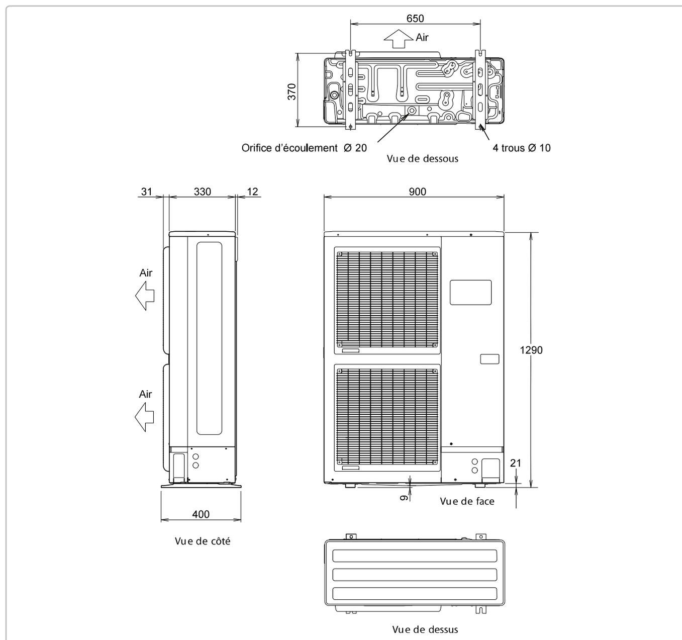
figure 1 - Unité extérieure : dimensions en mm
