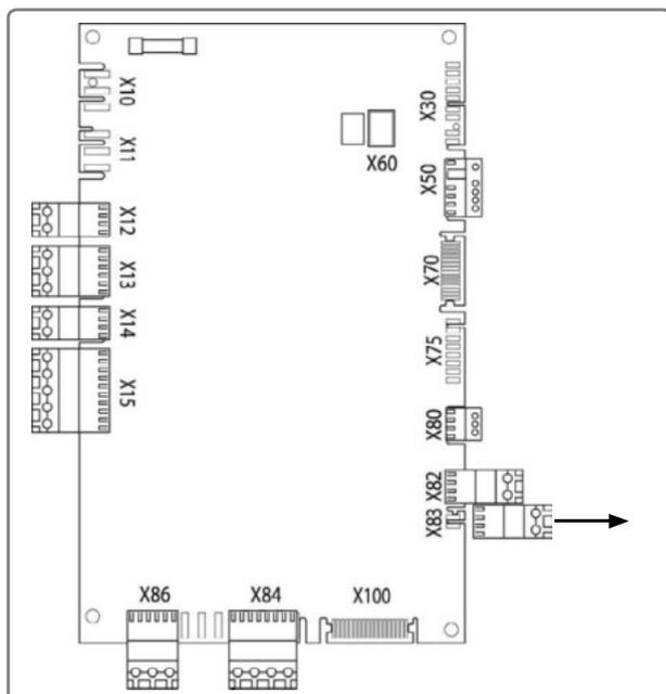
figure 23 - Emplacement du connecteur X83 sur le RVS 21, à débrancher
