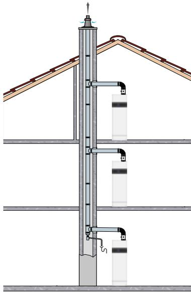
WaterMaster 25 (X) - 35 Evo en cascade avec installation cheminée de type C43.
