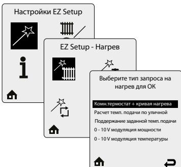
**Выберите тип запроса на нагрев для ОК** Меню выбора запроса системы отопления подсказывает установщику, как создается запрос системы отопления. Есть несколько вариантов формирования запросов на нагрев системы отопления, и установщик должен выбрать среди них.
