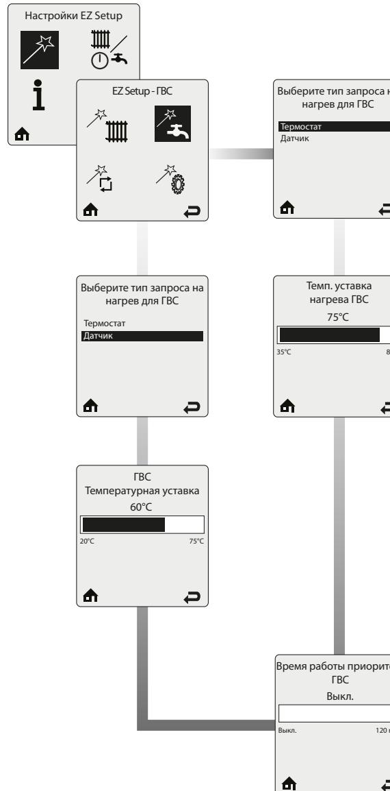
**Выберите тип запроса на нагрев для ГВС** определяет каким образом котел будет получать информацию о необходимости нагрева в режиме "ГВС". Из двух вариантов установщик должен выбрать подходящий.
