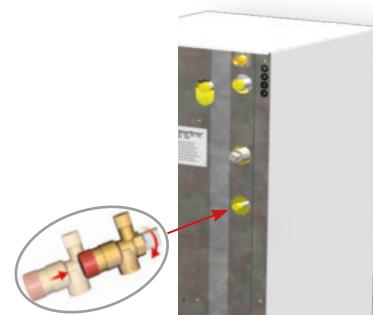
Установите конденсатоотводчик, убедившись, что все элементы установлены в правильной последовательности и подсоедините шланг к сливу с помощью подключения, которые могут быть проверены. Заполните сифон конденсатоотводчика водой. Убедитесь, в отсутствии рисков замораживания конденсата.
