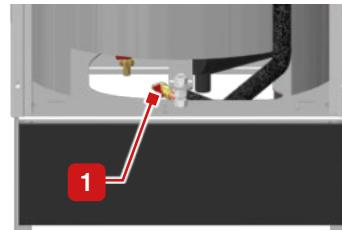
Циркуляционный патрубок оборудован краном, который открыт при поставке котла (для предотвращения замерзания остатков воды при транспортировке в холодное время года). Убедитесь, что вы закрыли кран при заполнении системы отопления.
