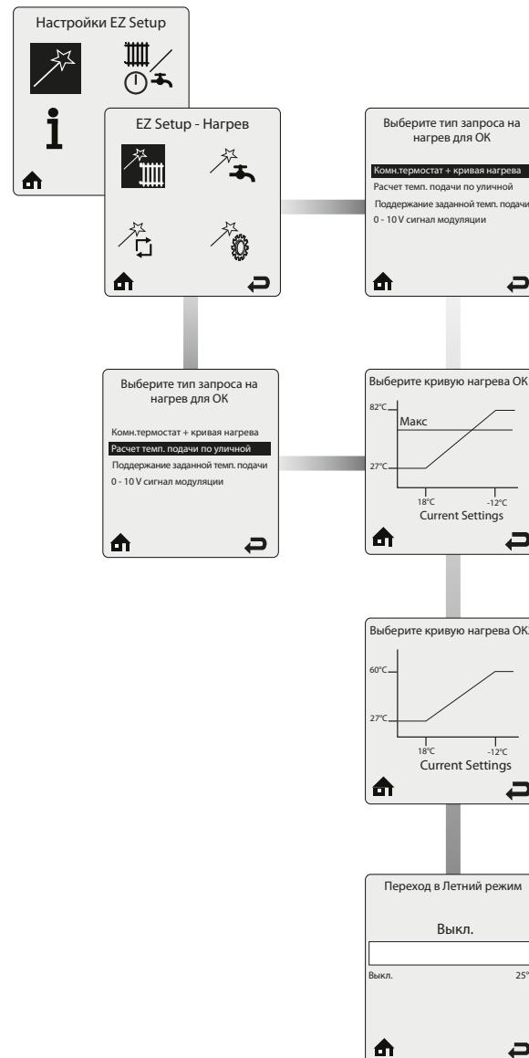
**Выберите тип запроса на нагрев для OK** - Меню выбора запроса системы отопления подсказывает установщику, как создается запрос системы отопления. Есть несколько вариантов формирования запросов на нагрев системы отопления, и установщик должен выбрать среди них.
