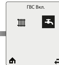
Меню **Запрос на нагрев ОК/ГВС** обеспечивает простой способ для включения/выключения либо Системы отопления либо ГВС.
