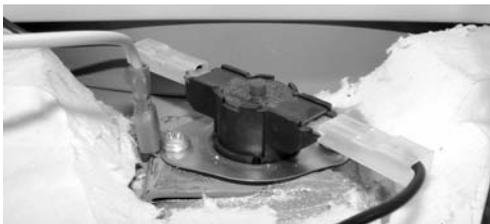
Fig. 23: Pulsante di riarmo del termostato di sicurezza
