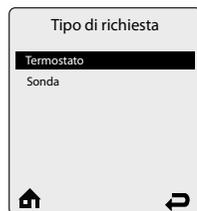
**Tipo di richiesta** permette all'installatore di scegliere quale tipo di dispositivo genererà una richiesta di acqua calda sanitaria.
