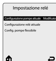
Il menu **Impostazione relé** permette di scegliere la corretta configurazione della pompa per la configurazione idraulica scelta. C'è una modalità di configurazione preimpostata e una modalità flessibile.
