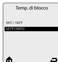
Questa impostazione della caldaia permette di testare la funzione termostato di surriscaldamento a una temperatura ridotta. Abbassa temporaneamente la temperatura di surriscaldamento dell'apparecchiatura a 39°C per permettere una dimostrazione sicura della funzione.
