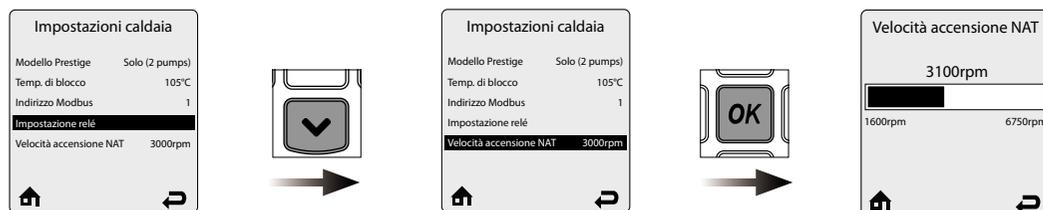
Questo parametro permette di modificare la velocità di accensione della caldaia.
