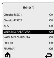
Selezionando **VALV. MIX APERTURA**, viene attivato il relé per il consenso di apertura della valvola miscelatrice. Il tempo di apertura di default è 120 sec.
