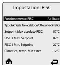
Il menu **Impostazioni RISC** contiene le impostazioni relative al funzionamento in riscaldamento. Ciascuna riga contiene un'impostazione di riscaldamento seguita dal suo valore attuale. Vengono visualizzate sullo schermo 6 impostazioni di riscaldamento alla volta.
