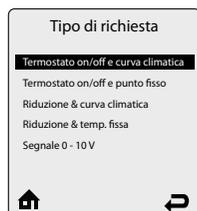
**Termostato on/off e curva climatica** – Una richiesta di riscaldamento dal termostato o comando remoto invia il consenso alla Prestige e il setpoint varierà in base alla temperatura esterna durante la richiesta di riscaldamento.
