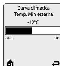
**Curva climatica temp. min esterna** è la temperatura esterna più fredda del sistema di riscaldamento quando l'opzione Curva climatica viene scelta in Tipo di richiesta. Questa impostazione non è disponibile quando l'opzione Setpoint viene scelta in **Tipo di richiesta**.
