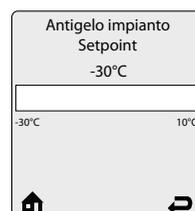
**Antigelo impianto Setpoint** permette di definire a quale temperatura esterna la protezione antigelo sarà attivata (disponibile solo se è collegato un sensore di temperatura esterna). Le pompe sono attivate quando la temperatura esterna scende al di sotto della soglia definita in questo menu..
