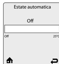
**Estate automatica** consente di inserire una temperatura esterna alla quale disabilitare la funzione di riscaldamento. La Prestige continuerà a rispondere alla richiesta di acqua calda sanitaria o ad un segnale 0- 10V anche se la temperatura esterna supererà tale valore.
