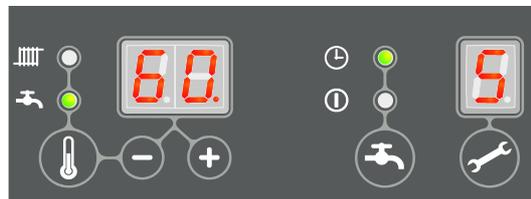
Nel caso in cui sia installato un termostato Open Therm, la temperatura di mandata è determinata dal termostato. Se è installata una sonda esterna, la temperatura di mandata è determinata dalla curva climatica programmata nel regolatore. In questi ultimi due casi, vale come massimo la temperatura di mandata impostata sul pannello di comando.
