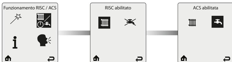
**Funzionamento RISC / ACS** fornisce un modo semplice per abilitare/disabilitare la funzione di riscaldamento/acqua calda sanitaria della HeatMaster.
