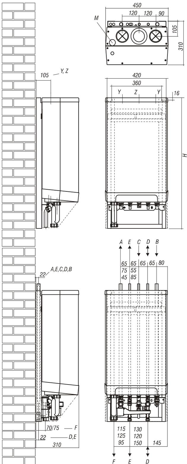
Appareil + étrier de montage + châssis de raccordement supérieur
