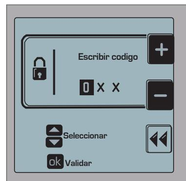
Pulse las teclas de pantalla correspondientes para alcanzar el valor deseado para el número seleccionado. (Código: 231). A continuación, pulse la tecla «OK» para ir a la siguiente posición.
