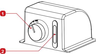
1. Termostato de ajuste [60/80°C]
