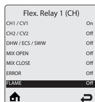
Selezionando **FLAME**, il relé viene attivato quando l'apparecchiatura sta funzionando e viene rilevato un segnale di fiamma.
